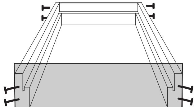
1. アルミ製下枠は枠外寸法・上枠は枠内寸法でカット
