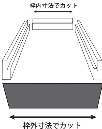
1. アルミ製下枠は枠外寸法・上枠は枠内寸法でカット
